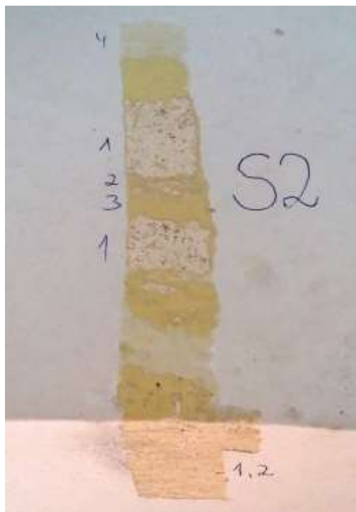
2. Sonda nad vstupem do chodby, vrstva č. 1 – na jemně zrnité omítce světle okrový vápenný nátěr, vrstvy č. 2 až 4 - mladší monochromní nátěry
