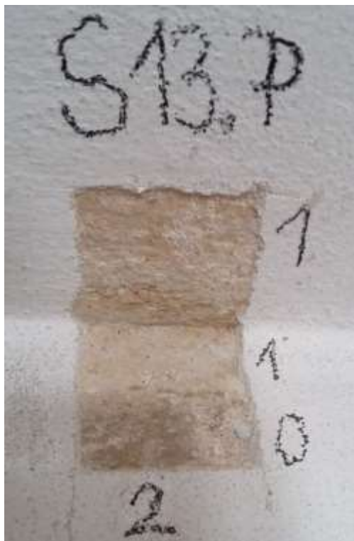
27. Sonda na rozhraní klenby a stěny, 1. okrová vrstva, 2. šedozelená se nachází pouze na kolmé stěně a kopíruje cca 2 cm od klenby její tvar
