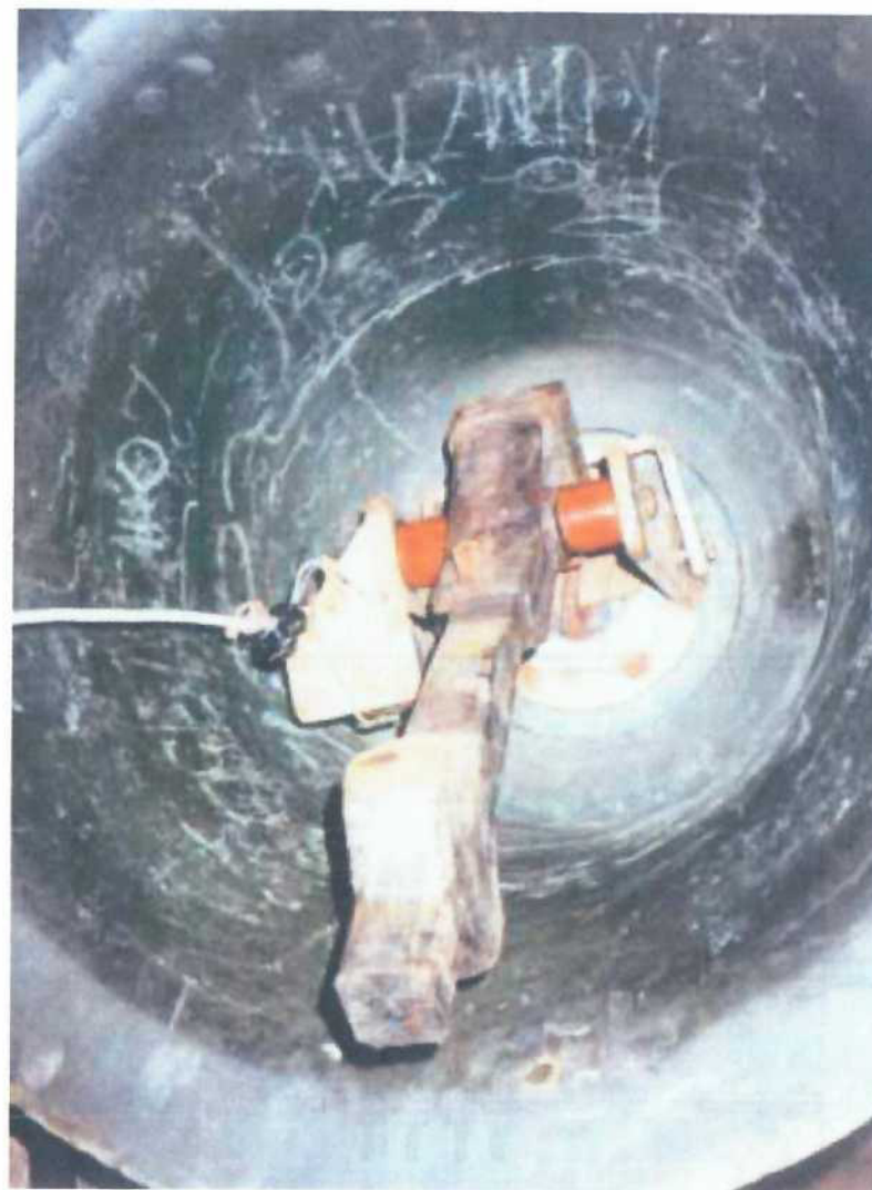
Obr. 5. Zvon z roku 1534 umístěný v kostele sv. Jiří v Božejově (okres Pelhřimov). Pohled dovnitř zvonu. Nevhodné srdce se sníženou osou otáčení, s protizávažím a zkrácenou výpusť a s přidavnou elektromagnetickou aretací srdce.
