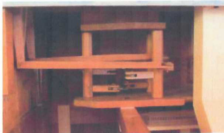
Obr. 24. Litomyšl (okres Svitavy), zámek, kaple sv. Michaela, varhany z doby okolo roku 1730. Restaurovaná registratura, rekonstrukce vzduchovodu.
