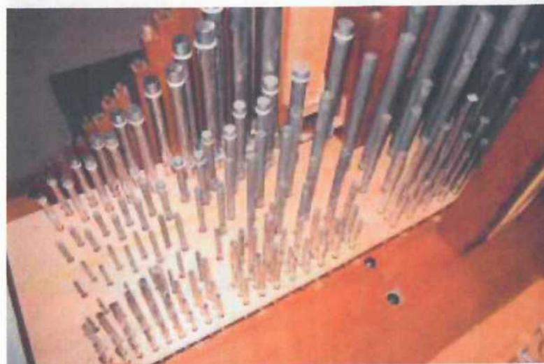
Obr. 25. Litomyšl (okres Svitavy), státní zámek, kaple sv. Michaela, varhany z doby okolo roku 1730. Píšťalový fond po restaurování a rekonstrukci unikátní píšťalové lavičky.
