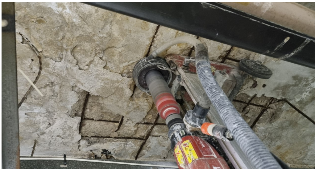
Obr. 4: Odběr jádrových vývrtů ze stropní konstrukce (V6)
