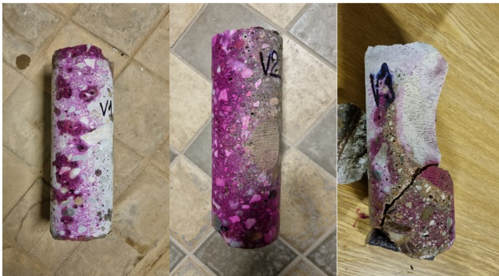
Obr. 5: Zkouška karbonatace betonu roztokem fenolftaleinu rozpuštěného v lihu (V1 až V3)
