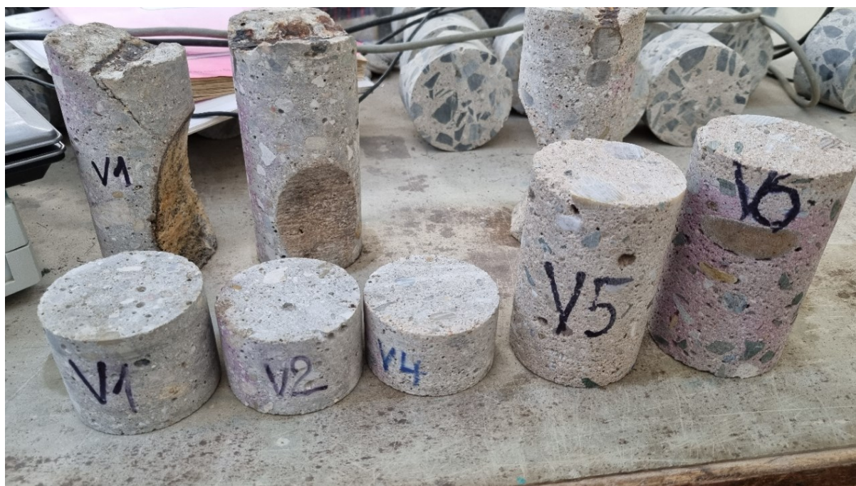
Obr.2: Upravené vzorky pro zkoušku pevnosti betonu v tlaku
