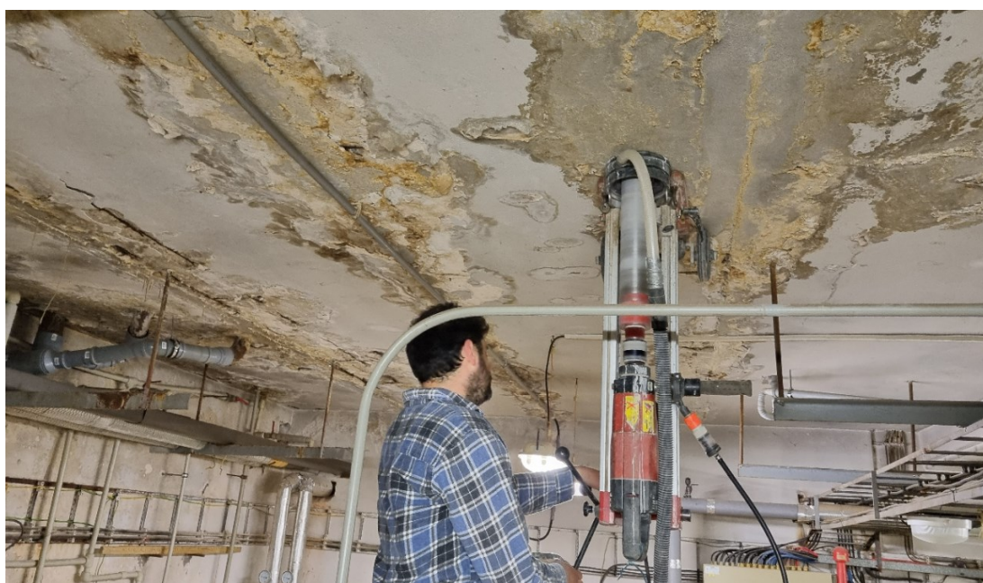
Obr. 3: Odběr jádrových vývrtů ze stropní konstrukce (V2)
