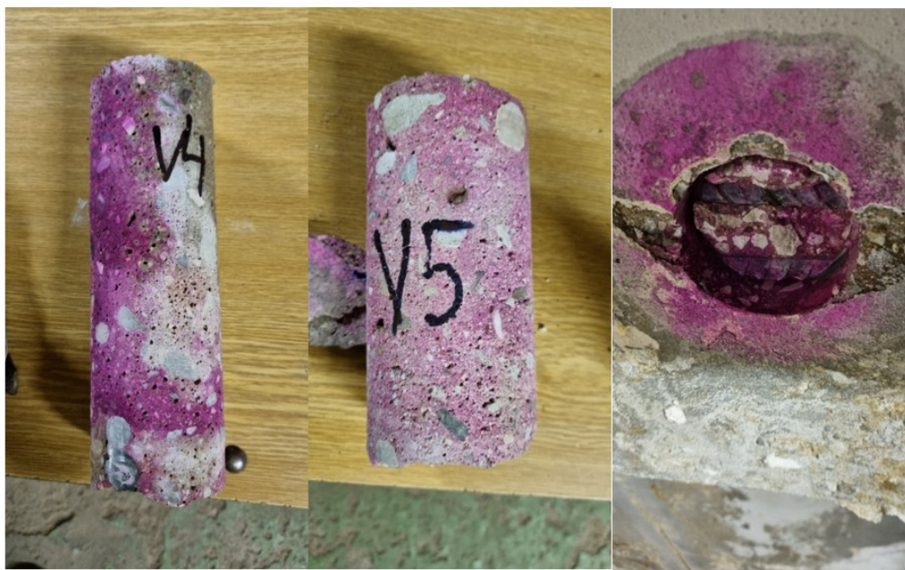
Obr. 6: Zkouška karbonatace betonu roztokem fenolftaleinu rozpuštěného v lihu (V4, V5 a K1)
