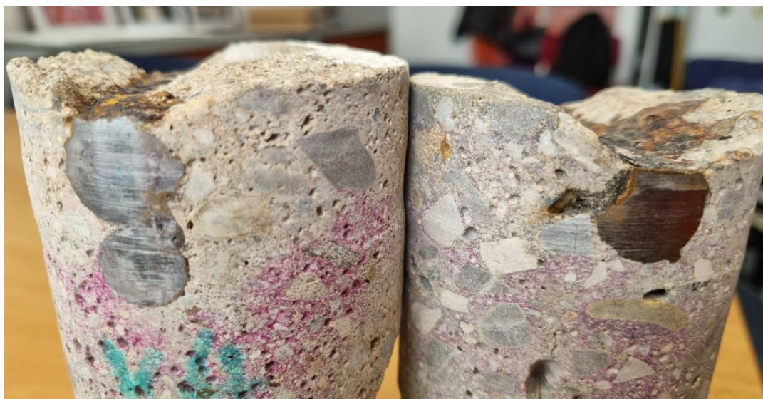
Obr. 9: Zjištěná betonářská výztuž panelů Spiroll
