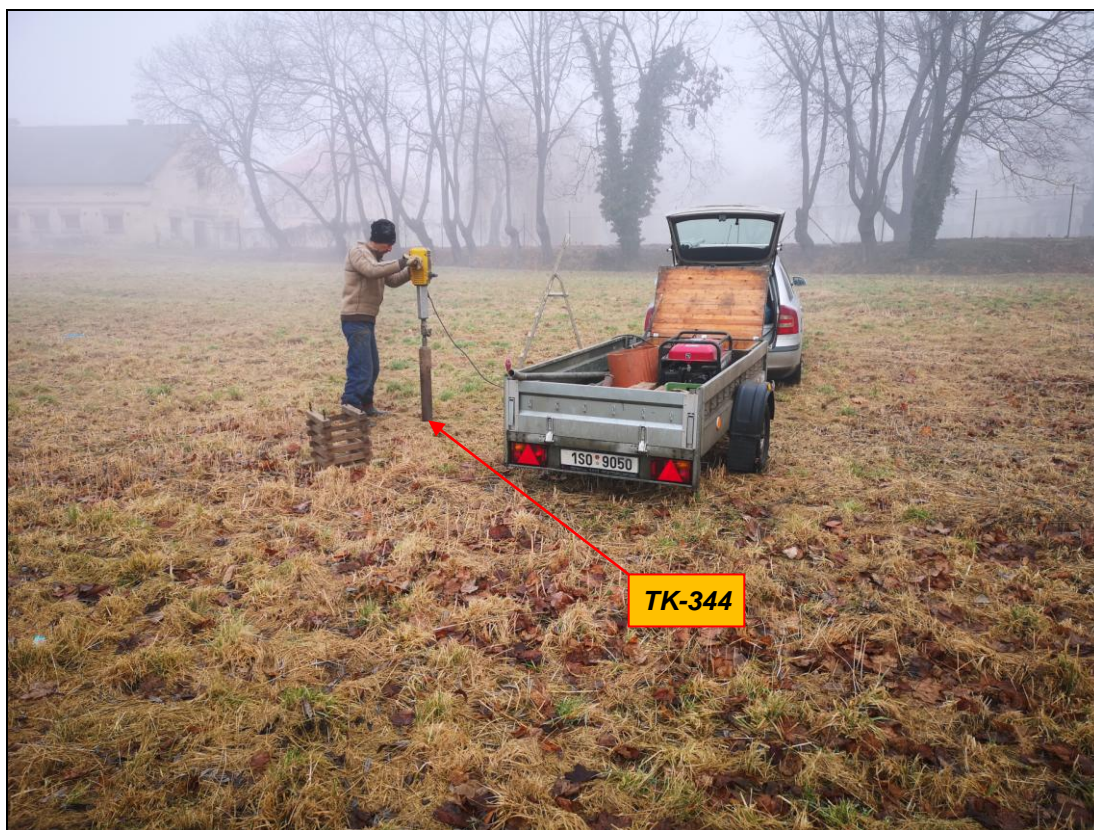
Foto č. 8-9 : Hloubení průzkumných jádrových vzorkovacích sond TK-343 a 344 elektr. sondážní soupravou WACKER EH 230/23 s pákovým adaptérem na vytahování sondážního soutyčí (konečná hloubka sond 1,00 m, průměr jádra 100 mm – foto 25.02. 2021)
