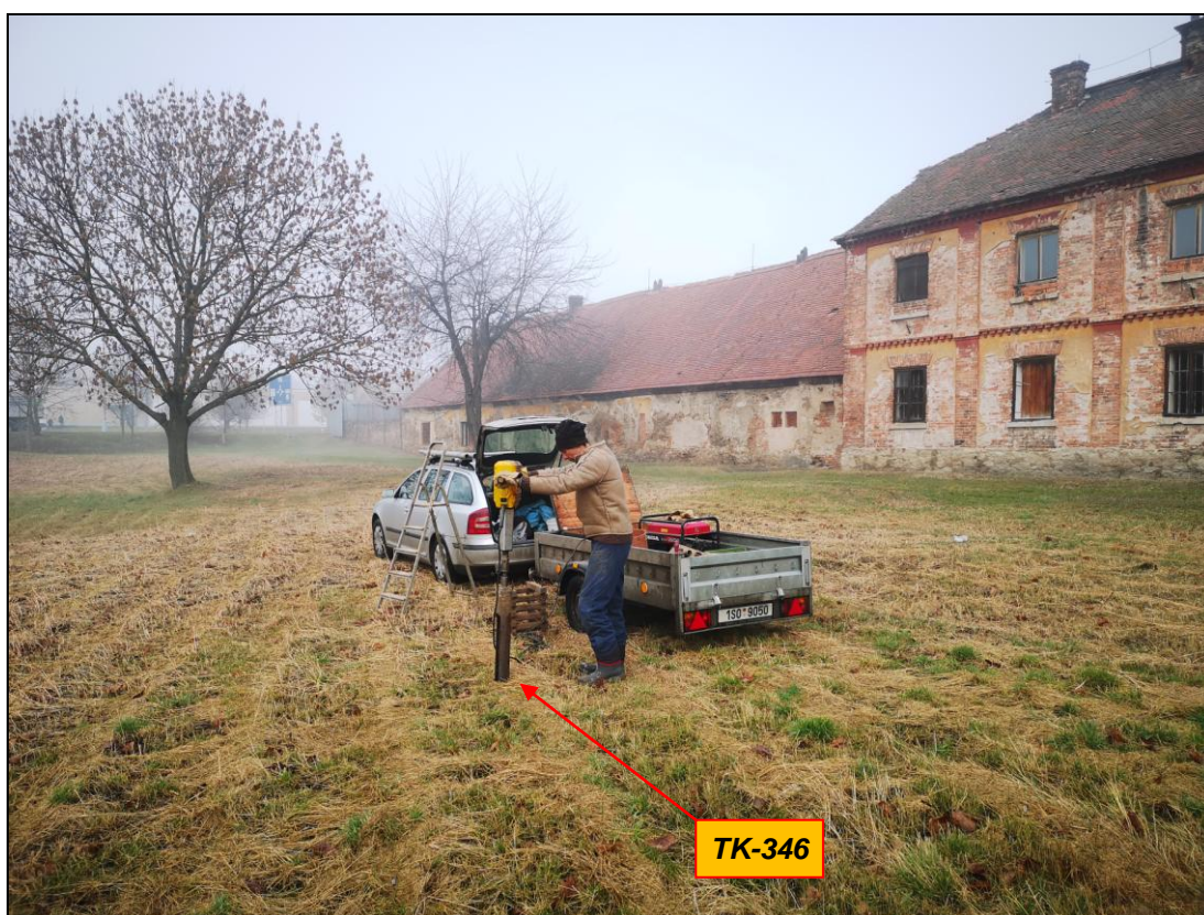
Foto č. 10-11 : Hloubení průzkumných jádrových vzorkovacích sond TK-345 a 346 elektr. sondážní soupravou WACKER EH 230/23 (konečná hloubka sond 1,00 m, průměr jádra 100 mm – foto 25.02. 2021)
