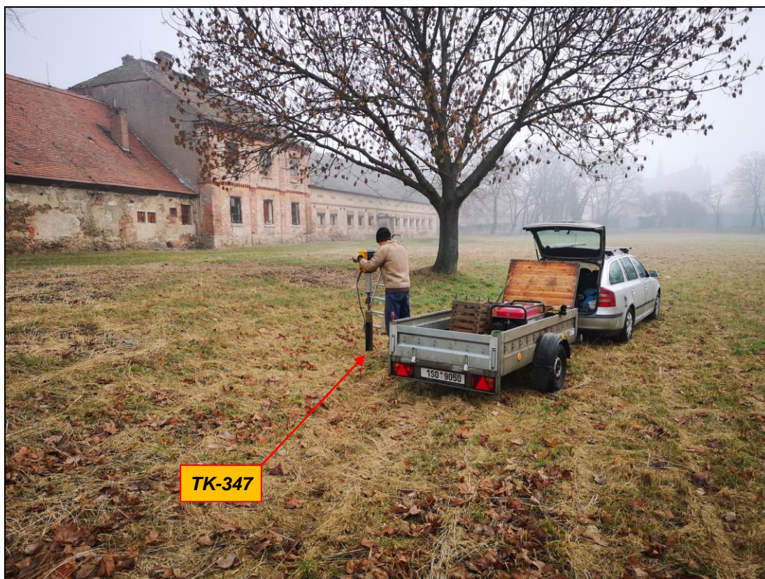
Foto č. 12 : Hloubení průzkumné jádrové vzorkovací sondy TK-347 elektrickou sondážní soupravou WACKER EH 230/23 s pákovým adaptérem na vytahování sondážního soutyčí (konečná hloubka sondy 1,00 m, průměr jádra 100 mm – foto 25.02. 2021)
