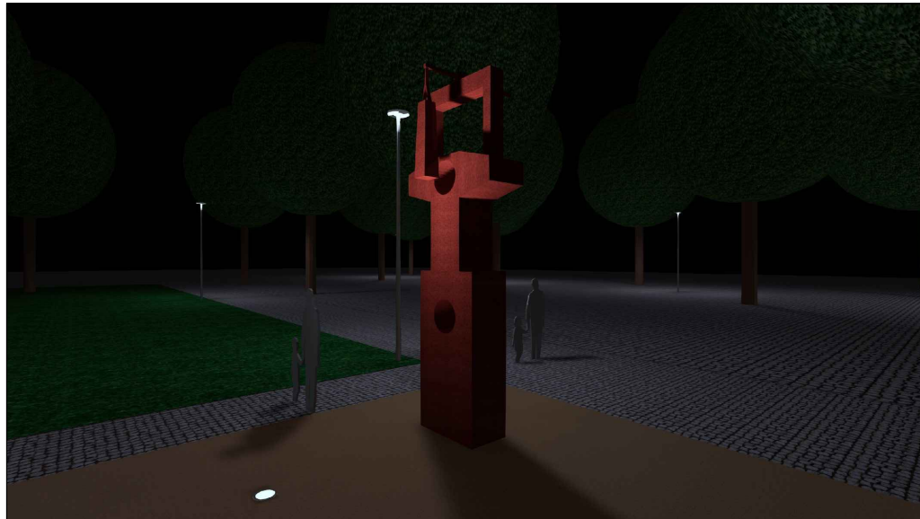
OSVĚTLENÍ SOCHY - JEDNO ZEMNÍ SVÍTIDLO VYKLOPENÉ O 25° VZDÁLENÉ 2,2 M OD STŘEDU SOCHY (REF. TYP IGUZZINI E143)
