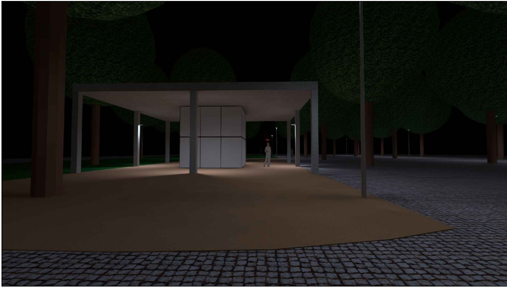
OSVĚTLENÍ PŘÍSTŘEŠKU - 4 SVÍTIDLA NA STŘEDNÍCH SLOUPECH VE VÝŠCE 3 M (REF. TYP IGUZZINI ALW2)
